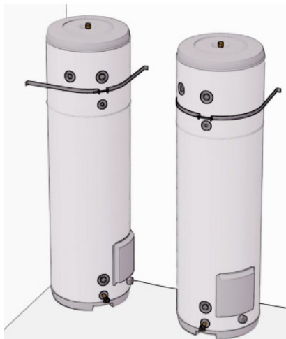
Tegningen er en illustrasjon som viser prinsippet for festene.
