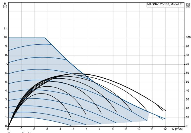
Pumpemedie = Vann Væsketemperatur under drift = 60 °C Massetetthet = 983.2 kg/m³
