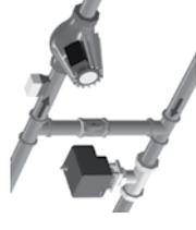
Kontroller, at rørets overflade er ren og jævn på det sted, hvor føleren monteres.
