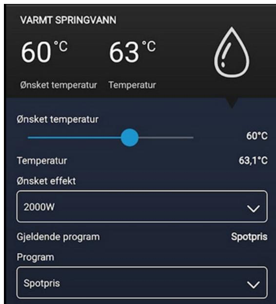
I Varmt springvann feltet vil gjeldende program være Spotpris, og i berederens display så vises ECO og Q som betyr at berederen styrer oppvarmingen etter spotpriser.
