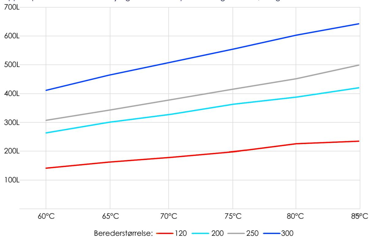
\*) Den mengde vann omregnet til 40 °C som kan tappes med fabrikkinnstilt temperatur på termostaten.
